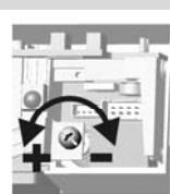
Чтобы приблизить луч к двери поверните винт по часовой стрелке, чтобы удалить от двери - против часовой стрелки
