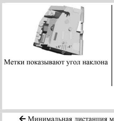
Метки показывают угол наклона
